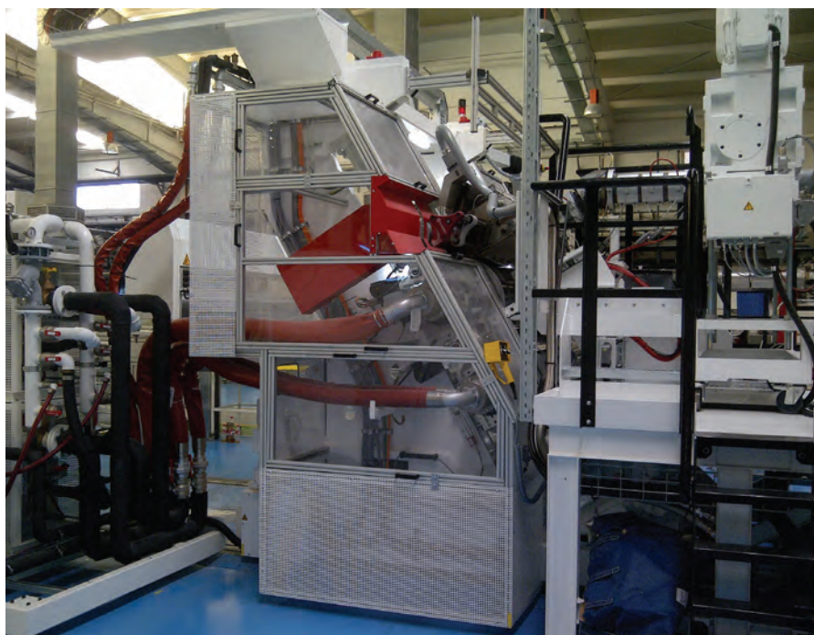
PET Coextrusionsanlage mit Inline-Lamination
